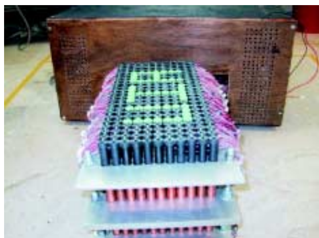
Figura 7. La figura de arriba muestra el PODÓMETRO UC visto desde arriba, las líneas blancas sobre los sensores forman parte de los patrones de calibración mecánicos. La figura de la parte de abajo muestra el ensamblaje final del prototipo, así como a la unidad de monitoreo al fondo.
