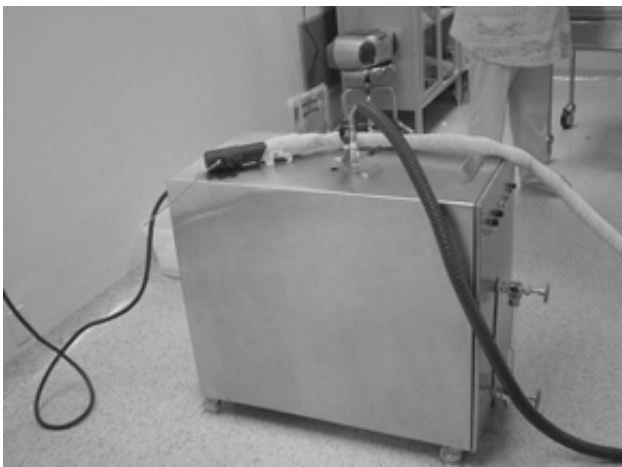
Figura 4. Generador de vapor.
