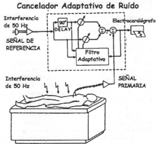
Figura 5: Esquema del cancelador del ruido de red.
