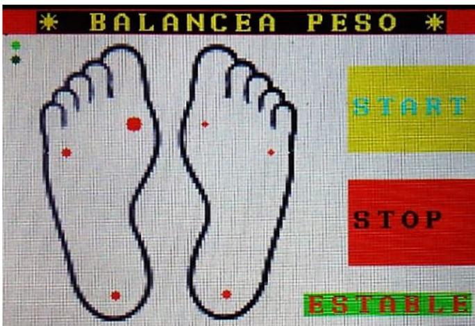
FIGURA 3. Pantalla touch del sistema donde se muestran los botones de inicio y paro de medición, magnitud de la fuerza aplicada a cada sensor y el estado de estabilidad o no.
