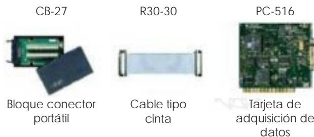
Figura 4. Elementos constitutivos del módulo de adquisición de datos.
