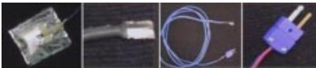
Figura 2. Termocupla tipo "T" modo de fijación, electrodo, cable de extensión y terminal.
