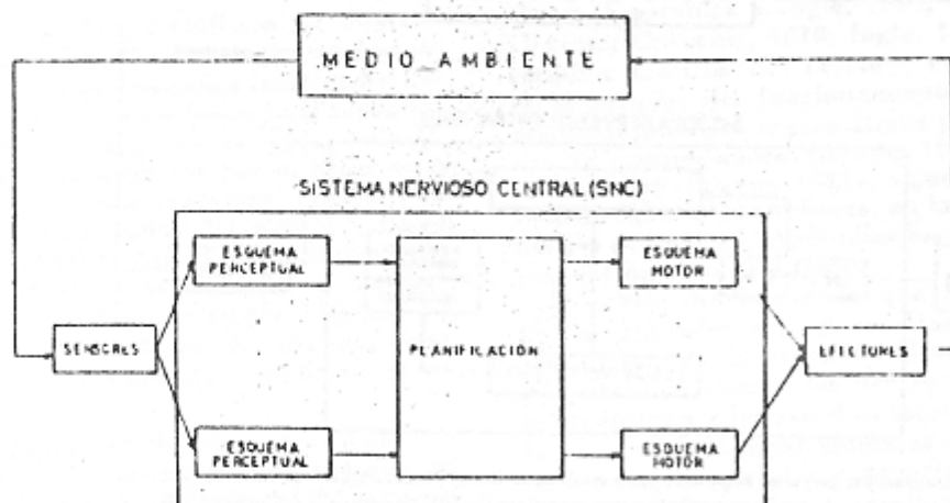
Figura 2 Coordinación sensorio-motora de acuerdo a la teoría de esquemas. El estado interno del organismo se actualiza con nuevos estímulos, cuya representación interna (esquema perceptual) es usada por el organismo (planificación) para decidir que acción (esquema motor) debe ser producida (adaptado de Arbib, 1981)
